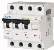
FI/LS; 16A; 30mA; curva caratteristica LS: C; 3p+N; curva caratteristica FI: AC
