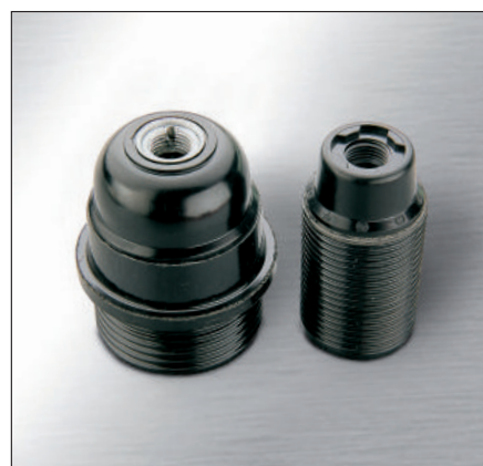
Portalampada in termoplastico: a sinistra con attacco E27 camicia parzialmente filettata e nippel in metallo; a destra con attacco E14, camicia filettata e con filetto stampato.
