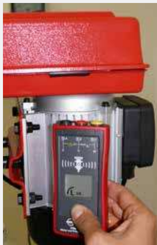
Rilevamento wireless della rotazione del motore
