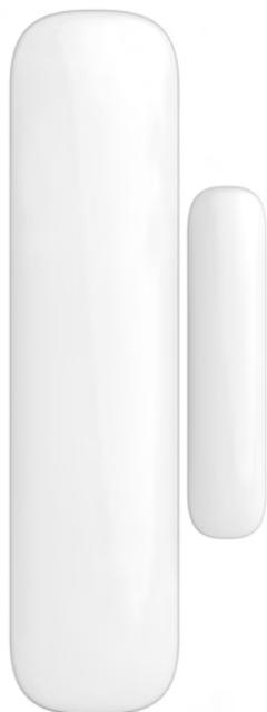
Sensore che può essere installato su porte, finestre e qualsiasi altro oggetto che si apre e si chiude. Il sensore trasmette un segnale al pannello di controllo quando le due parti si allontanano l'una dall'altra. La protezione anti-manomissione garantisce che qualsiasi tentativo di sabotaggio provochi l'attivazione dell'allarme.
